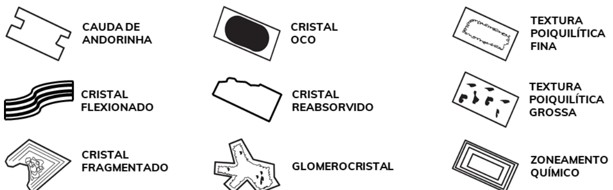
Figura 4.3 - Exemplos de microtexturas em feldspatos. Modificado de Renjith (2014).
