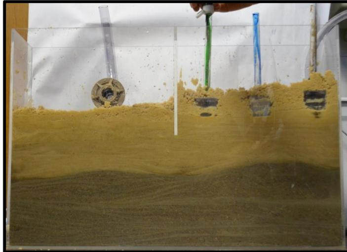
Figura 12: Adição de corantes de anilina para visualização do fluxo da água.
