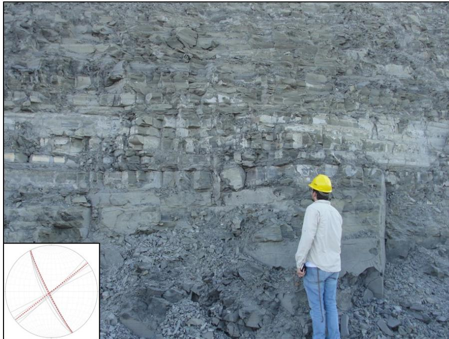
Figura 14. Fraturas conjugadas localizadas próximas ao contato “xisto intermediário – xisto inferior”. Coordenada 556740/7145304.
